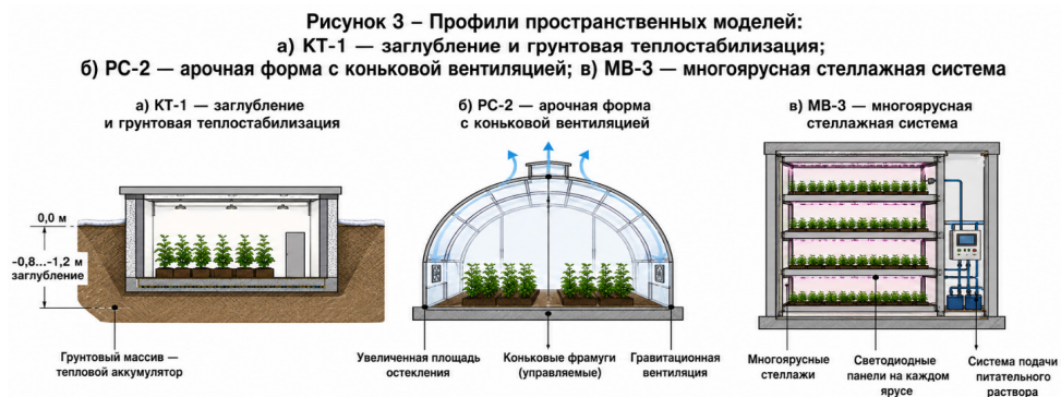
Рисунок 3 – Профили пространственных моделей: а) КТ-1 - заглубление и грунтовая теплостабилизация; б) РС-2 - арочная форма с коньковой вентиляцией; в) МВ-3 - многоярусная стеллажная система.
