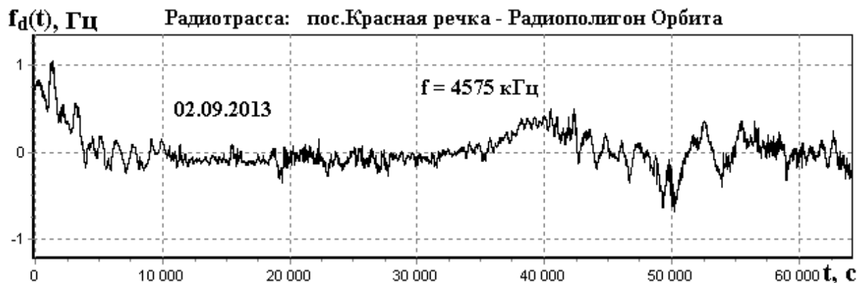
Рисунок 3 – Пример записи вариаций доплеровского сдвига частоты. По оси X – время от начала суток 02.09.2013 г. по времени GMT в секундах
