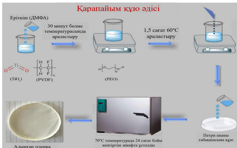
1-сурет. Құю әдісінің схемасы
