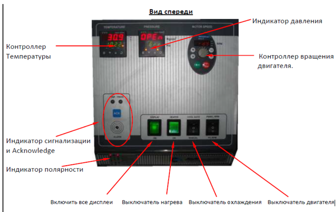
Рисунок 1 – Электрическая панель управления автоклава Amar Equipments Pvt. Ltd
