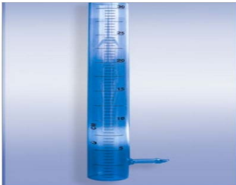
1-сурет-Судың мөлдірлігін анықтауға арналған Снеллен цилиндри.
