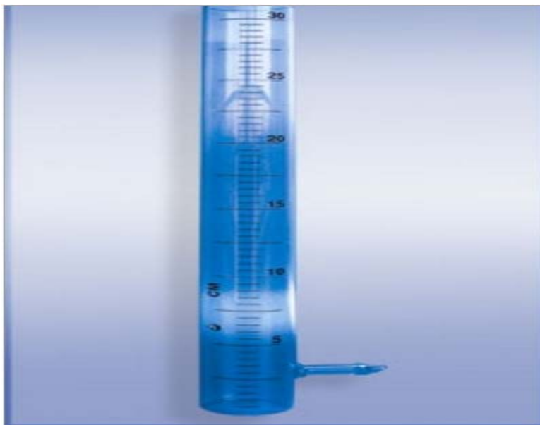
1-сурет-Судың мөлдірлігін анықтауға арналған Снеллен цилиндірі.
