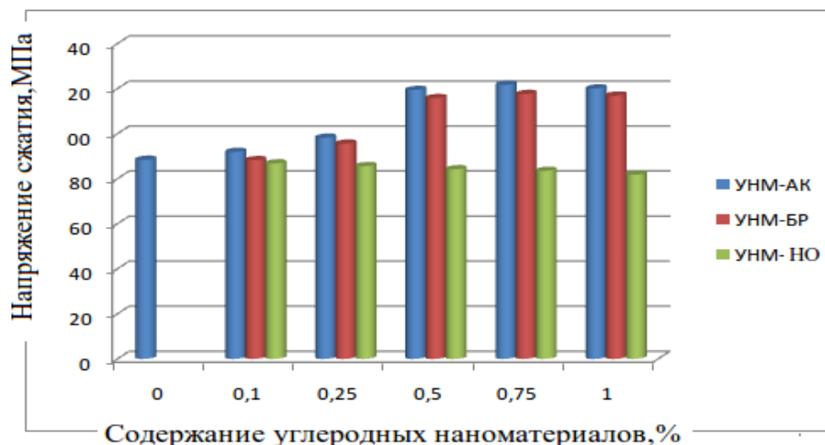
Рисунок 3 - Зависимость предела прочности при сжатии образцов ПКМ от содержания добавок углеродных наноматериалов: УНМ-АК – УНМ обработанные с азотной кислотой, УНМ-БР – УНМ обработанные парами брома, УНМ-НО- необработанные УНМ
