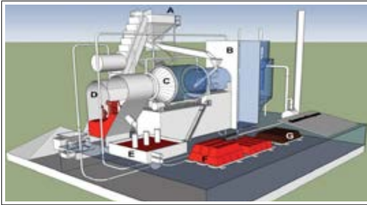
Рисунок 1 – Модель пилотной установки по переработке техногенных отходов.
