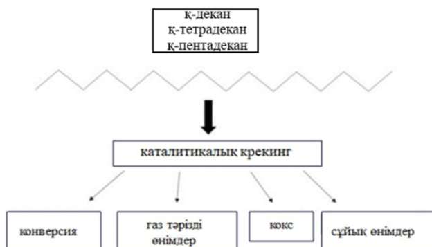
Сурет 4 — Ауыр алкандарды каталитикалық крекингпен өңдеу нәтижесінде түзілетін өнімдер
