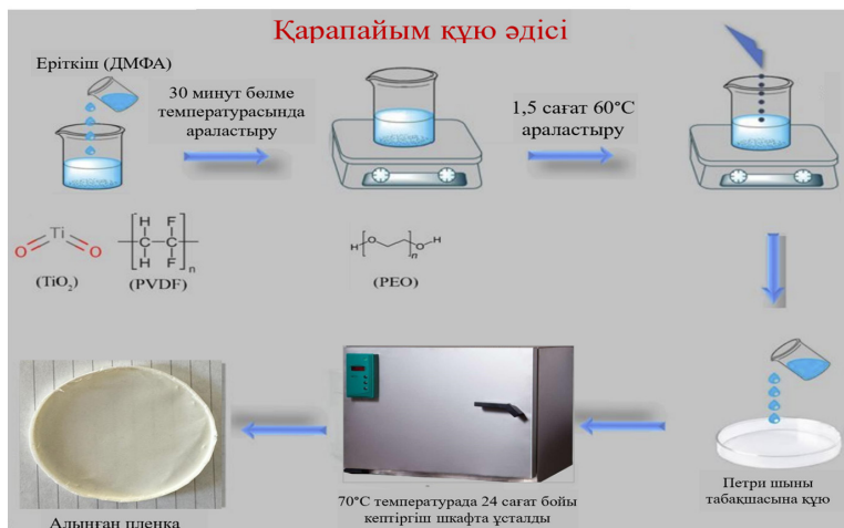
1-сурет. Құю әдісінің схемасы
