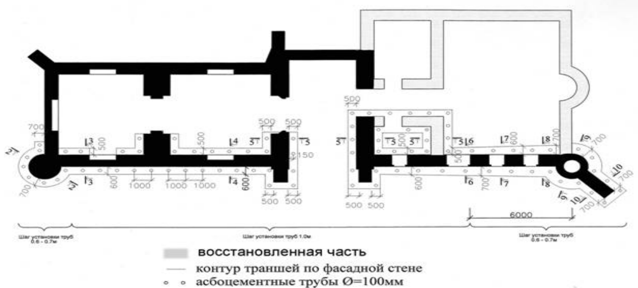
Рисунок 3 – Схема расположения траншей и вентиляционных труб
